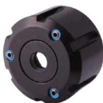
Spannmuttern DIN 6499 (ISO 15488) System ER, mit Spritzdüsen, für Dichtscheiben Clamping nuts DIN 6499 (ISO 15488) ER-system, with spray nozzles, for sealing discs Ecrous de serrage DIN 6499 (ISO 15488) système ER, avec gicleurs, pour joints
